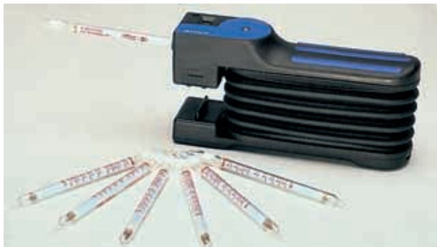
FIGURA 2. Tubos detectores de ozono Dräger y bomba de aspiración manual accuro
