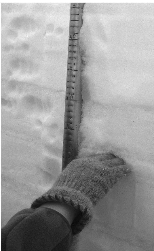
Foto 1. Medida de la dureza de la nieve. Este debe realizarse siempre con el guante puesto. En la fotografía vemos que el observador puede introducir los cuatro dedos, por lo tanto la capa tiene una dureza de 2 es blanda.
