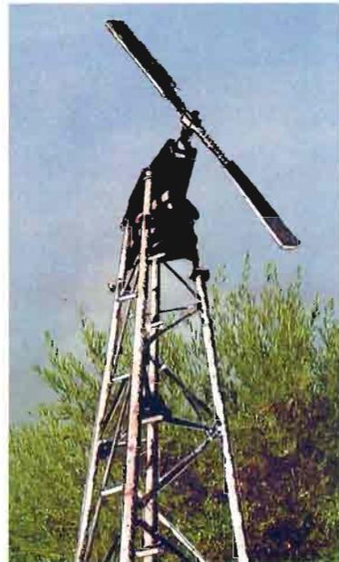
Fig. 2. Torre ventiladora. La altura del eje de las palas del ventilador ha de estar entre los 12 y 14 metros de altura. El diámetro de las palas, de 3 a 5 metros, girando a 600/800 revoluciones por minuto. El ventilador ha de girar sobre su eje vertical a razón de una vuelta cada 3 minutos, aproximadamente.
