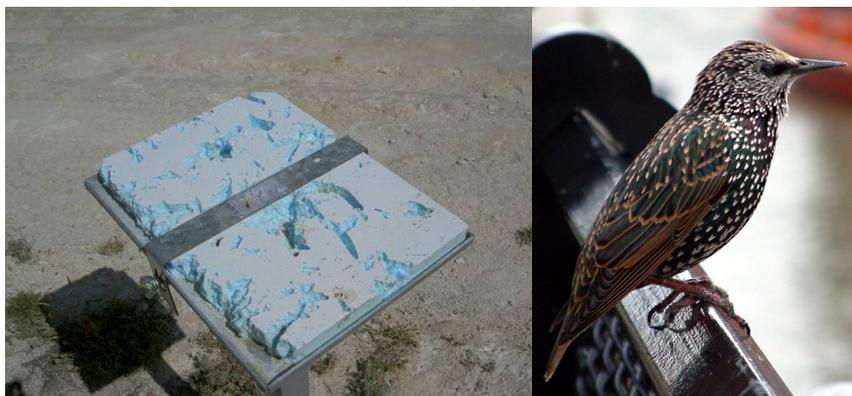
**Figura 4.3 Granizómetro destrozado por los estorninos (izquierda) y estornino (derecha).**
