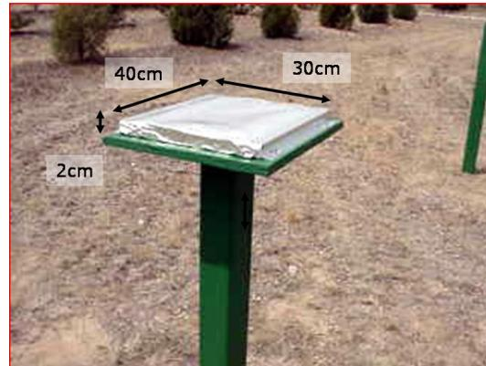
**Figura 4.1 Granizómetro y sus medidas.**
