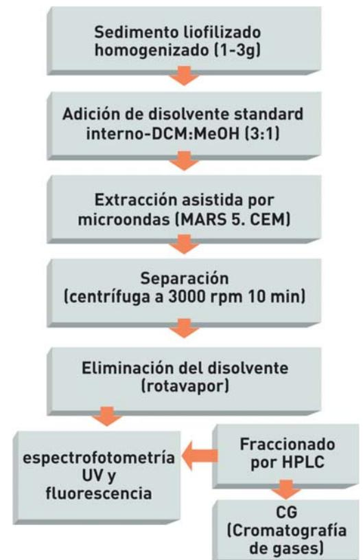
**Figura 5.** Esquema de la metodología analítica para analizar clorinas total en muestras de sedimentos.
