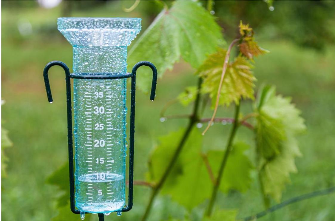
Los pluviómetros no solo recogen agua procedente de la lluvia, también son recolectores de la deposición de gotitas procedentes de nieblas particularmente densas y persistentes.
