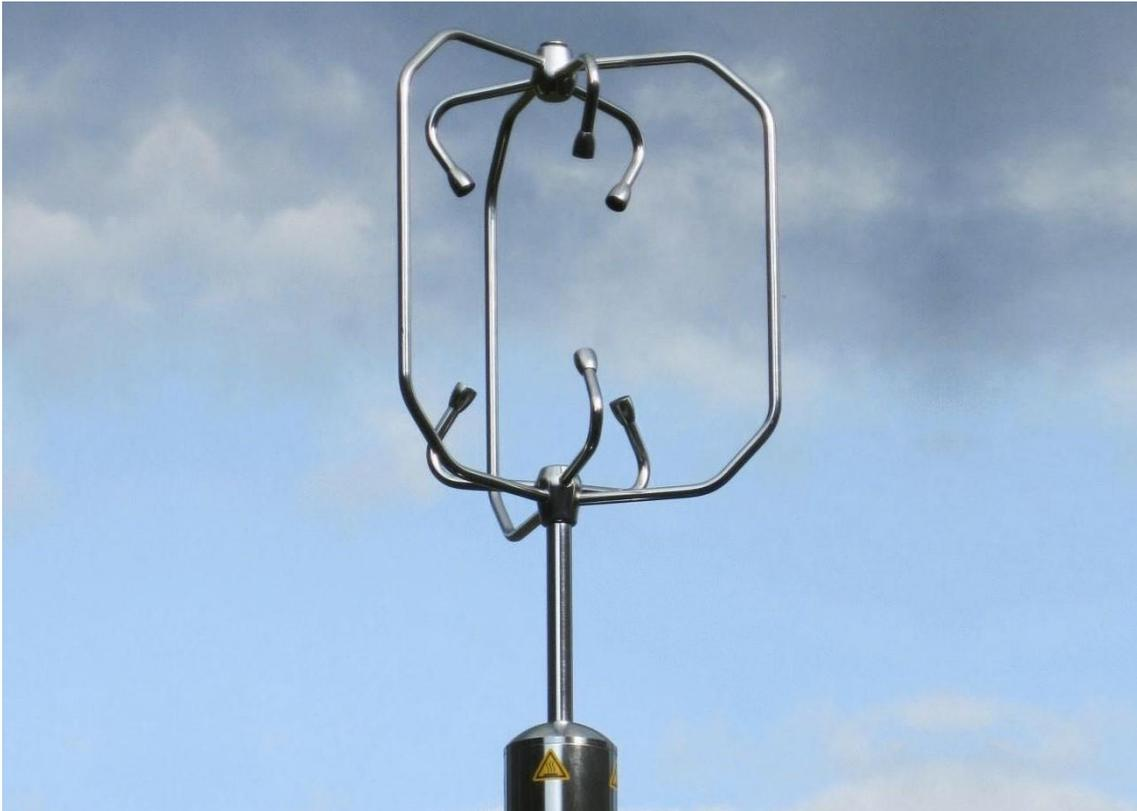
Anemómetro sónico o ultrasónico, cuyo fundamento está basado en la emisión de pulsos de ultrasonidos.
