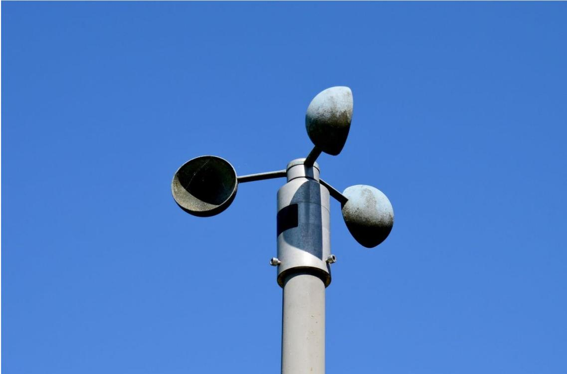
El anemómetro de cazoletas es el instrumento medidor de la intensidad del viento de uso más extendido.
