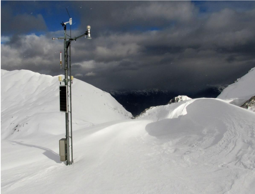
Telenivómetro de ultrasonidos ubicado en una ruta de montaña en los Alpes bávaros, en las cercanías de la localidad alemana de Berchtesgaden. Fuente: Wikipedia
