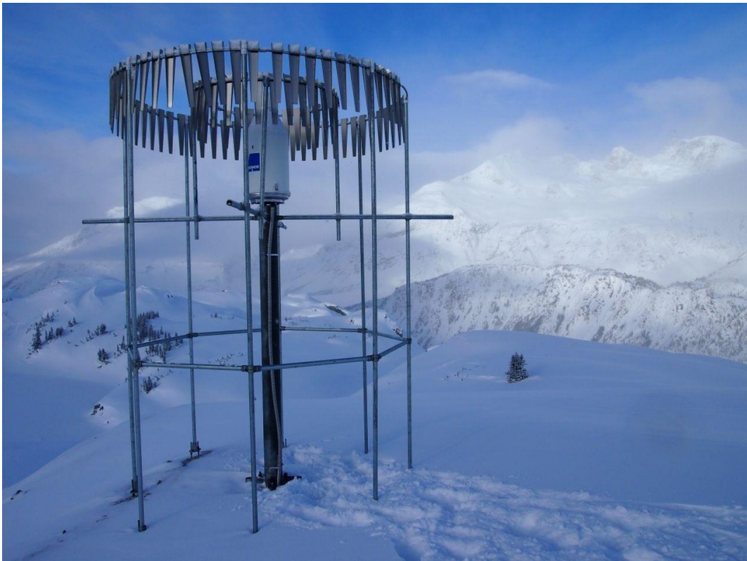
Nivómetro con doble escudo protector en un emplazamiento de alta montaña. Fuente: https://geonor.com/
