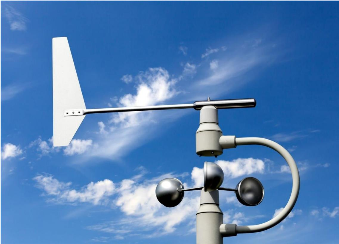
Anemómetro de cazoletas y veleta en lo alto de un mástil anemométrico
