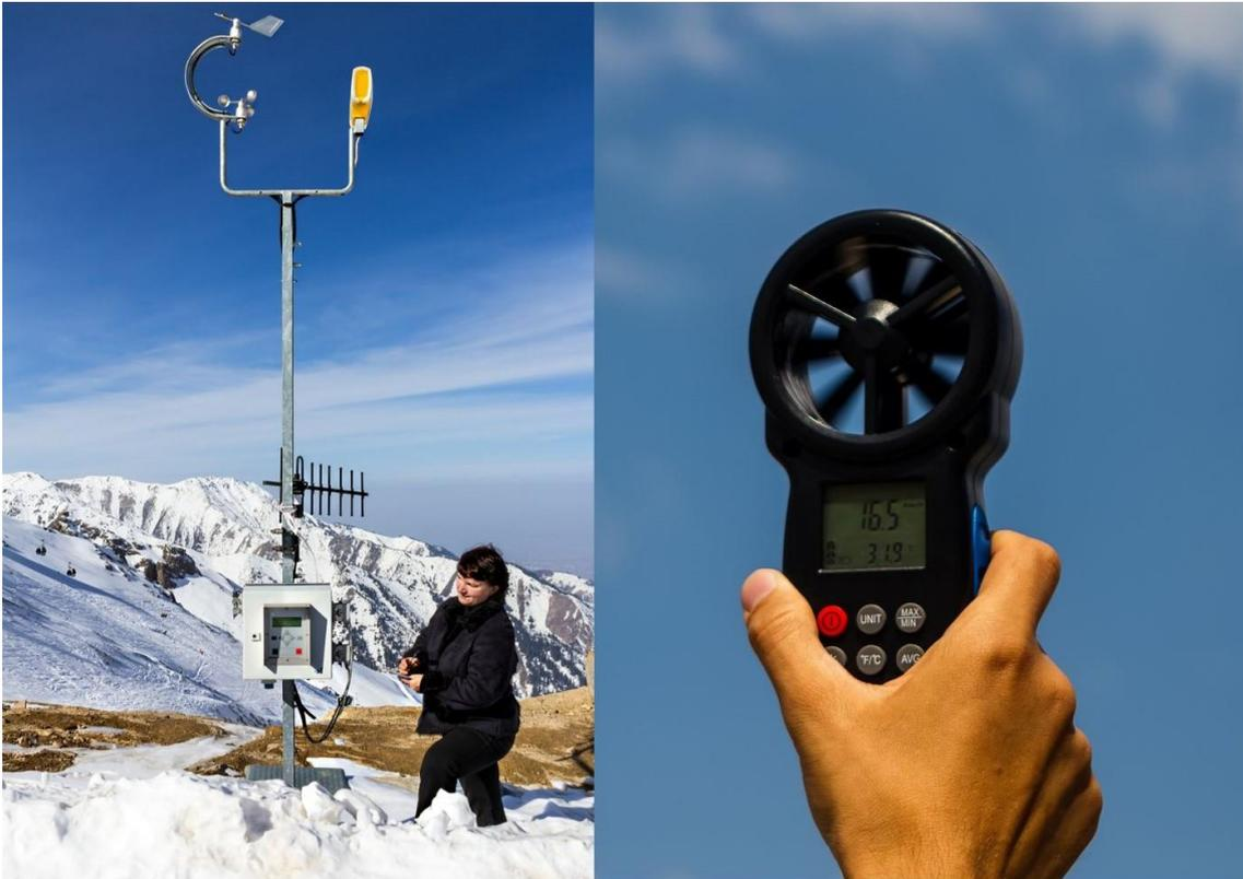
Izquierda: Estación meteorológica automática ubicada en una zona de alta montaña, que incluye instrumentos medidores del viento en lo alto del mástil. Derecha: Anemómetro portátil, que obtiene una medida directa e inmediata de la intensidad del viento.
