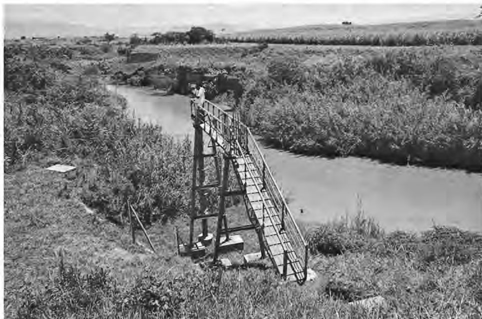
Instalación de un limnógrafo — Estudio hidrometeorológico de las cuencas de los lagos Victoria, Kyoga y Mobutu Sese Seko (Foto OMM)
