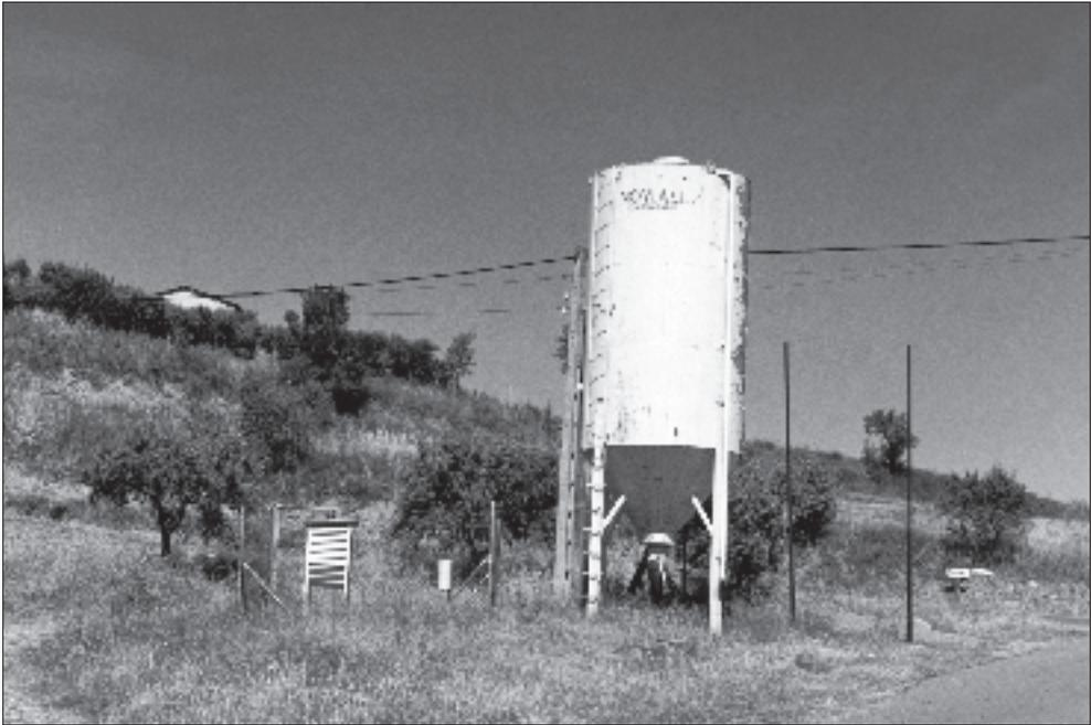
Estación meteorológica de Naval. Muy cerca del pluviómetro se halla un depósito de gran altura que puede alterar la correcta recogida de las precipitaciones, principalmente cuando sopla el viento
