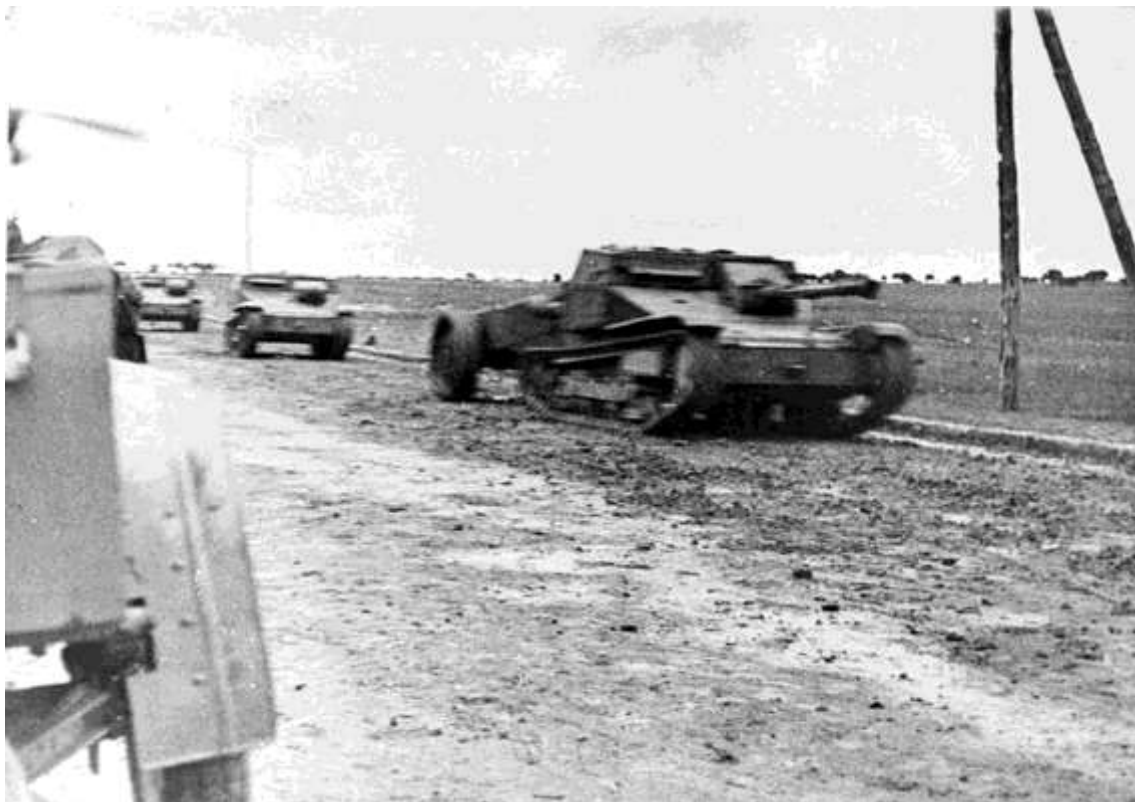
Tanquetas italianas lanzallamas, se las diferencia por el cañón delantero y por el remolque blindado donde iba la cisterna con el combustible. Fuente: Bundesarchiv, República Federal de Alemania.
