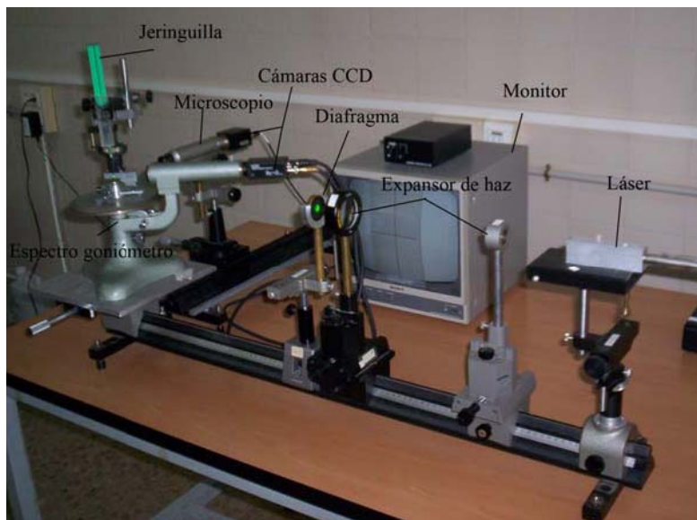
Fig. 11. Montaje experimental para realizar medidas de los ángulos de desviación de un haz de luz monocromático a través de gotas de agua y de esferas de vidrio.
