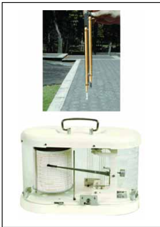
Figura 5. Instrumentos sencillos para medir humedad en la atmósfera (psicrómetro e higrómetro de cabello).
