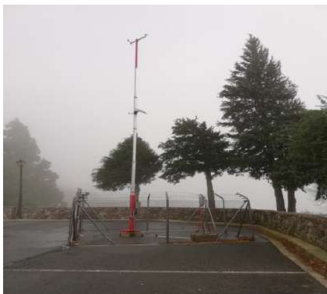
Figura 16.4. Estación de Cruz de Tejeda, con el arbolado en su radio de influencia
