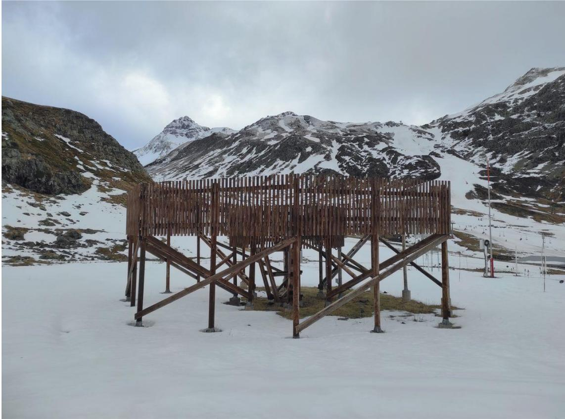
Pluviómetro de pesada rodeado de un doble vallado de madera que actúa como barrera anti-viento, instalado en la estación meteorológica de AEMET situada en la zona de Sarríos en la estación de Aramón Formigal. Fotografía tomada por José Miguel Viñas el 18 de enero de 2024.
