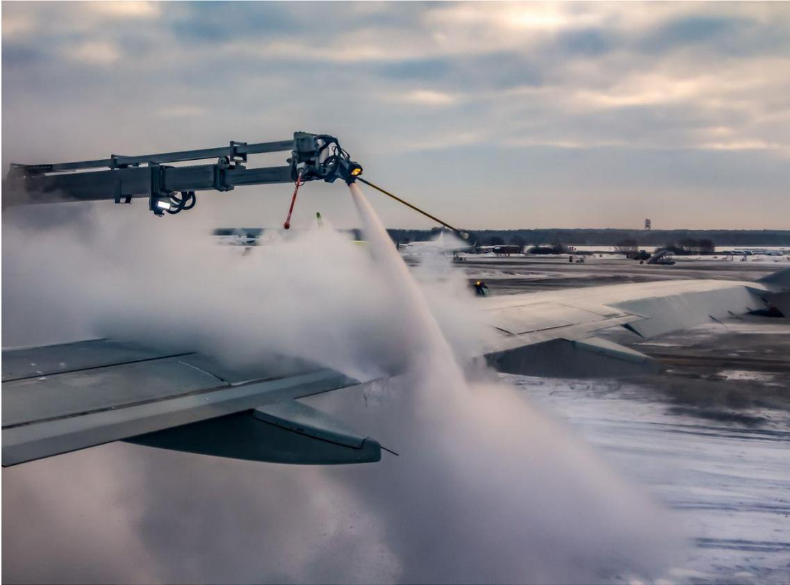
Operación de deshielo sobre las alas de un avión estacionado en un aeropuerto
