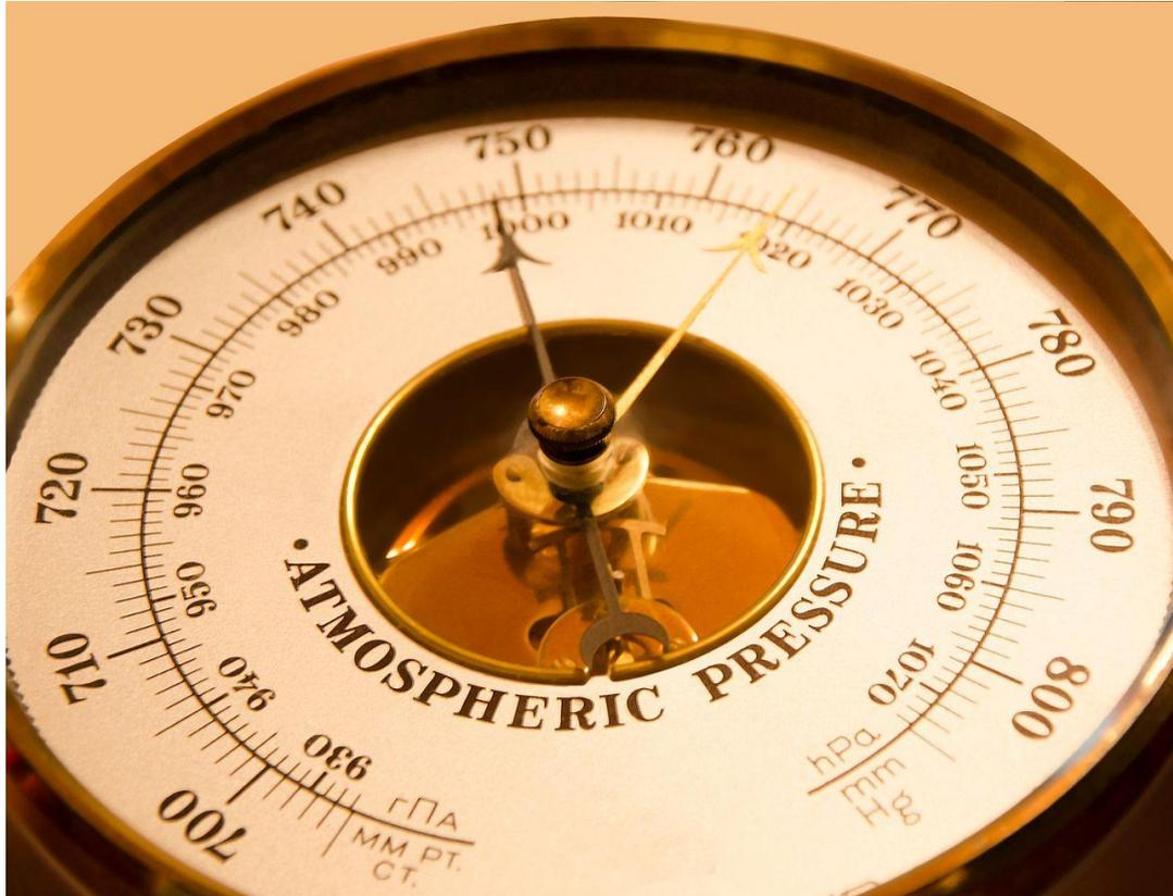
Barómetro aneroide. Este instrumento permite medir la presión atmosférica gracias a las contracciones y dilataciones de una cápsula en la que se ha hecho un semivacío, contenida en su interior.
