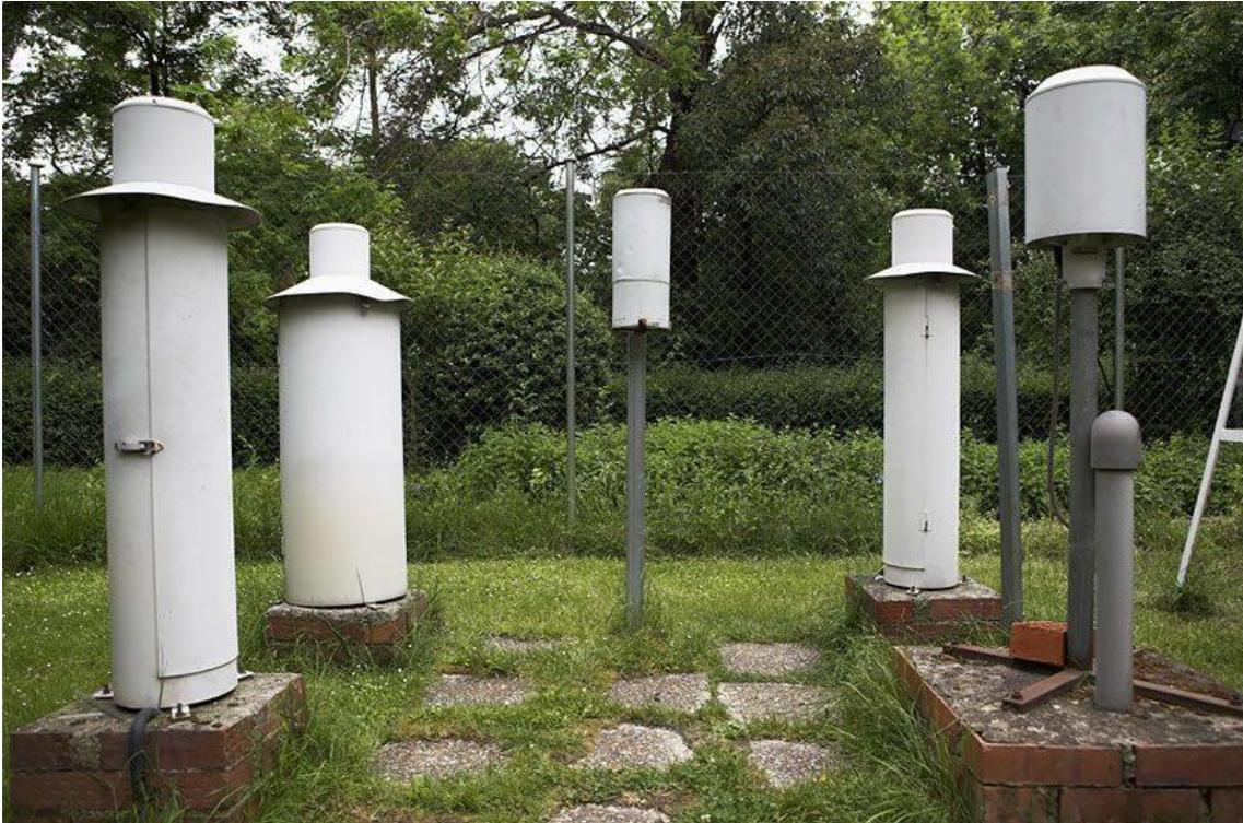
Distintos pluviómetros y pluviógrafos del Observatorio meteorológico del Retiro, en Madrid. El del centro es el clásico pluviómetro Hellmann. Crédito: © Agencia Estatal de Meteorología
