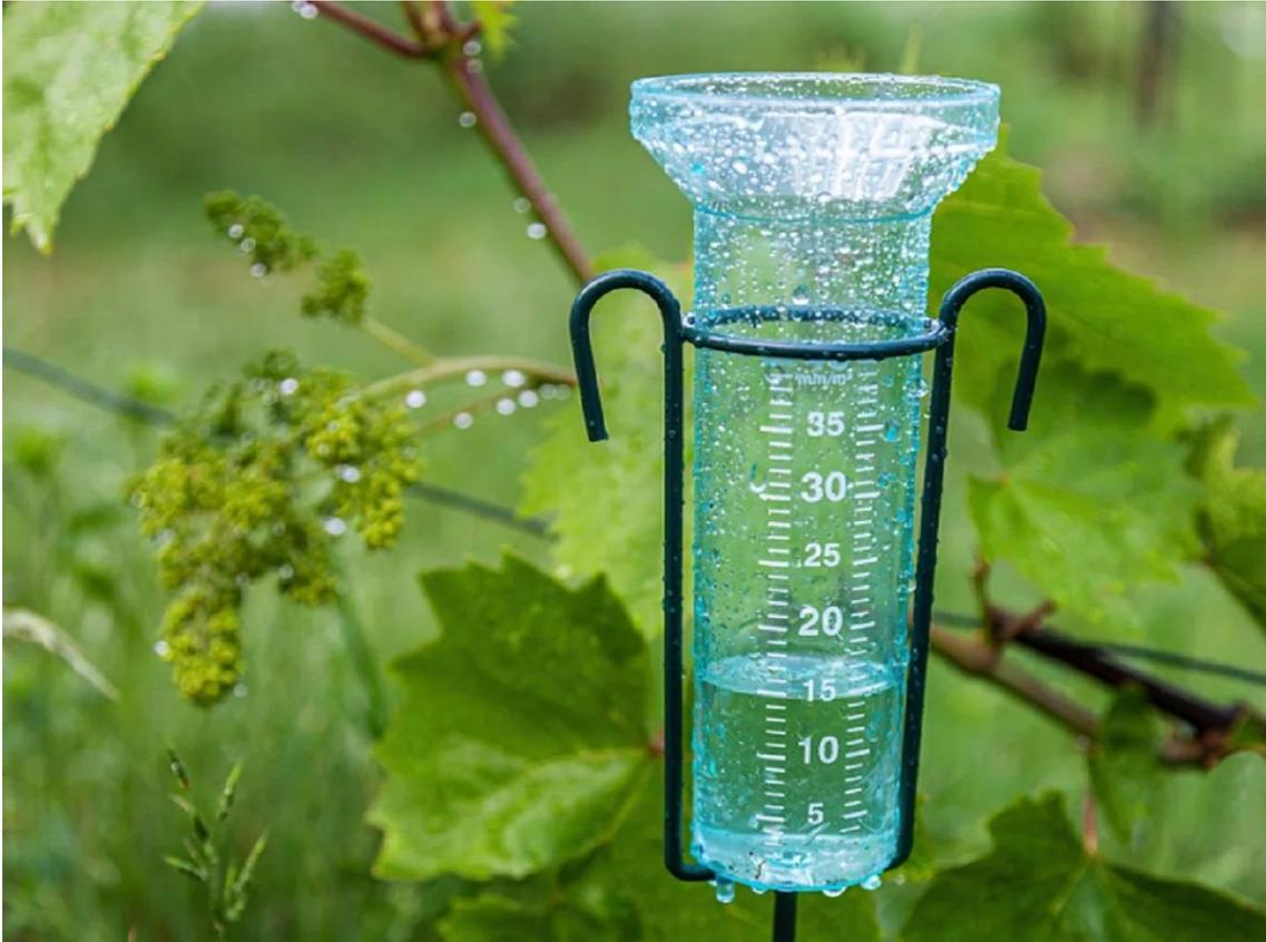
Pluviómetro de plástico de uso muy extendido en el mundo agrícola para llevar un registro de la pluviometría a pie de campo. En unos viñedos, en la fotografía. Foto: © Vadym Zaitsev
