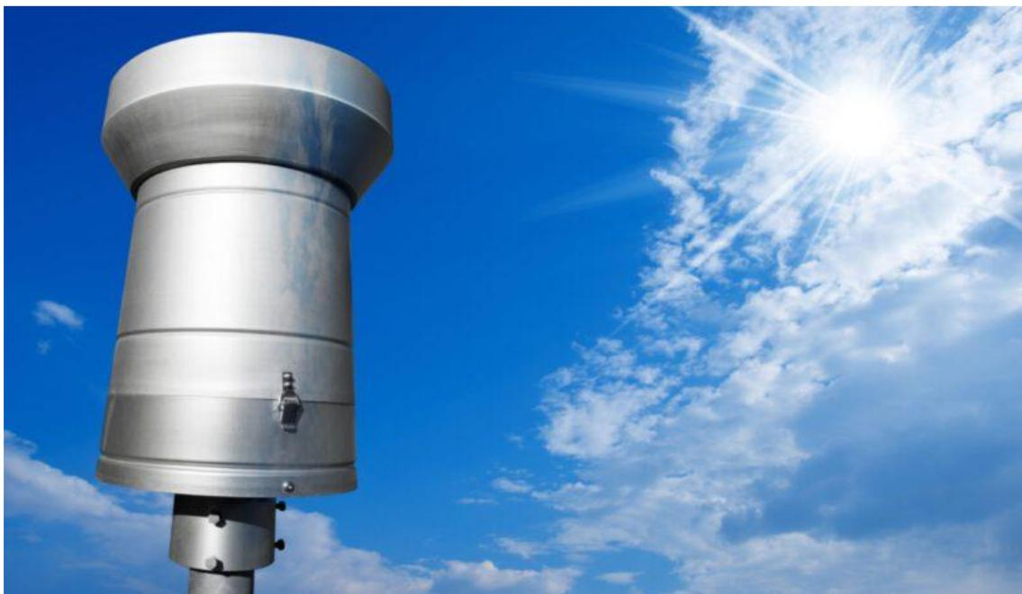
Pluviómetro metálico de una estación meteorológica moderna.
