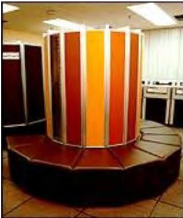
Figura 7: Primer supercomputador Cray-1A del ECMWF. Estaba compuesto de un único procesador de 80 MHz y 8 Mb de memoria y un almacenamiento en disco de 2.4 Gb y una potencia pico teórica de 160 MFLOP.
