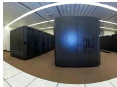
Figura 9: Uno de los clusters de IBM formado por Each cluster has 768 servidores POWER7-775 conectados mediante IBM Host Fabric Interface (HFI). Cada uno tenía una potencia pico de 1.5 PFLOPS.
