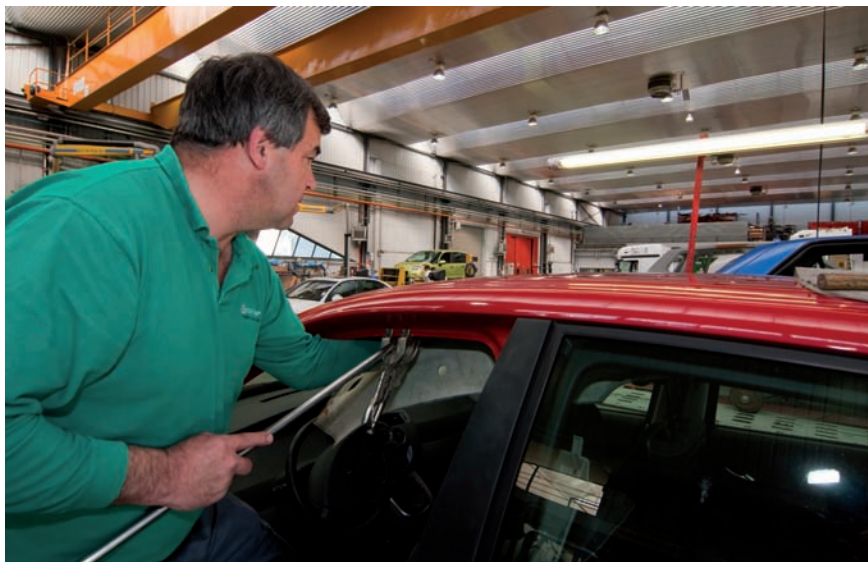
■ Reparación utilizando técnicas de empuje
