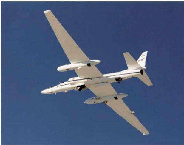
Figura 42: El ER-2 convertido en un complejo laboratorio de fisicoquímica, está listo para estudiar el Agujero del Ozono Austral. Los detectores se hallan en los tubos bajo las alas, en los extremos de las mismas y varios sitios de la parte inferior del cuerpo del avión.
