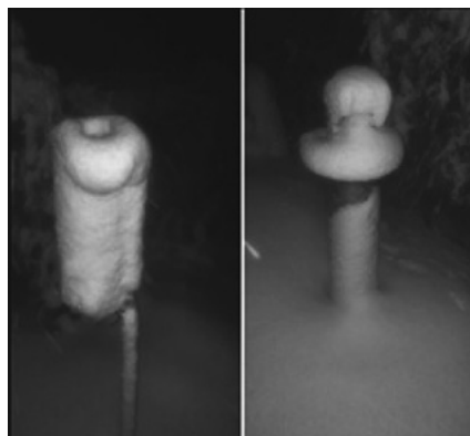
Figura 11. Imágenes de pluviómetro y pluviógrafo de la estación de Orgaz (Toledo), cortesía de David Resuela Sánchez, colaborador de AEMET en la localidad. Se observa como ambos quedaron bastante taponados por la nieve, incluso en el caso del pluviógrafo que estaba calefactado.
