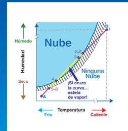
1. El escape húmedo y caliente de la aeronave se enfría al mezclarse con el aire hasta que alcanza la saturación en la curva de condensación.
