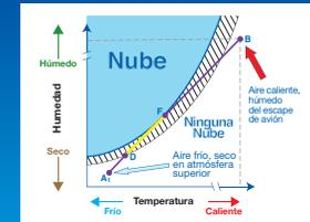
El escape del avión se mezcla con el aire de la atmósfera a lo largo de la línea entre los puntos B y A. Una estela se forma en el punto F y persiste hasta el punto D. Cuando la línea recta entre los puntos A y B tan apenas se cruza con la curva de condensación, se forma una estela de vapor pasajera.
