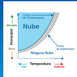
El área azul en sombra (fría y húmeda) muestra las condiciones donde la condensación (de gas a líquido) ocurre en la atmósfera. Debido a que hace frío donde los aviones vuelan, cualquier gota de agua que se forme en el escape de la nave, se transformará en hielo (de líquido a sólido) al poco de formarse. El área a rayas muestra donde el hielo permanecerá. En el área blanca, el hielo se sublimará (de sólido a gas).
