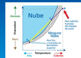
Cuando el punto A está en la zona rayada (aire húmedo), la adición del escape caliente y húmedo del avión lleva a la formación de estelas persistentes, posiblemente que se expanden ya que las partículas de hielo formadas en el punto F no se sublimarán en el punto A.
