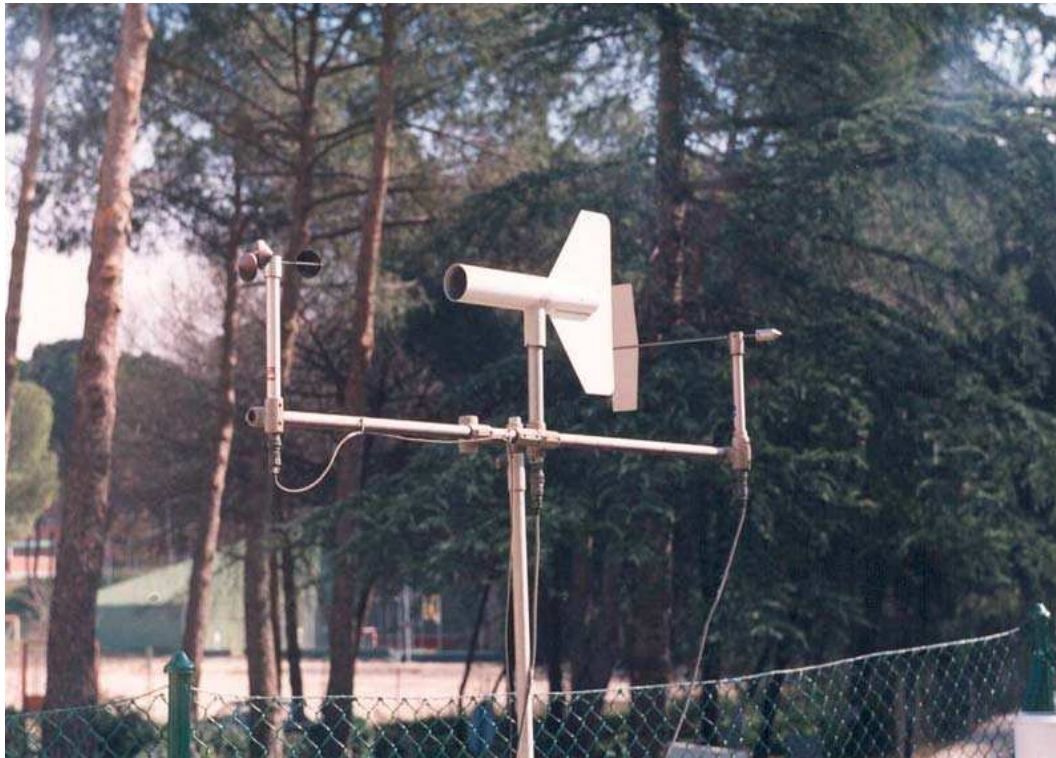
Fotografía 3. Anemometro de cazoletas (izquierda), anemómetro sónico (medio) y veleta (derecha).
