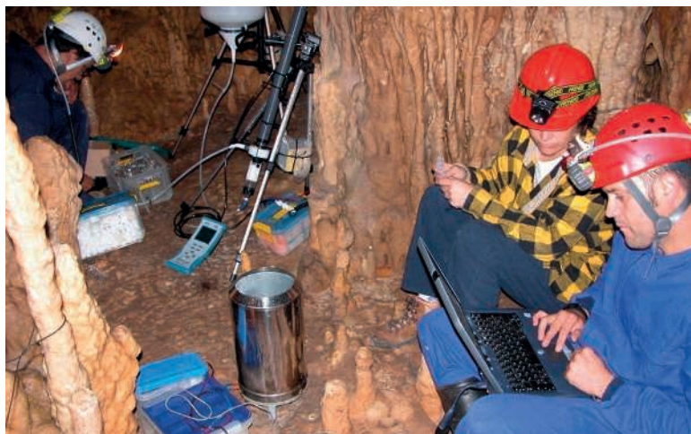
Los trabajos de monitorización hidroquímica y ambiental en cuevas son claves para modelizar el sistema kárstico y para entender y calibrar los registros paleoclimáticos que se obtengan en él.
