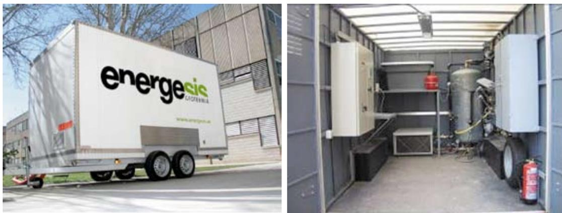
Figura 7. - Laboratorio móvil para la caracterización térmica del suelo
