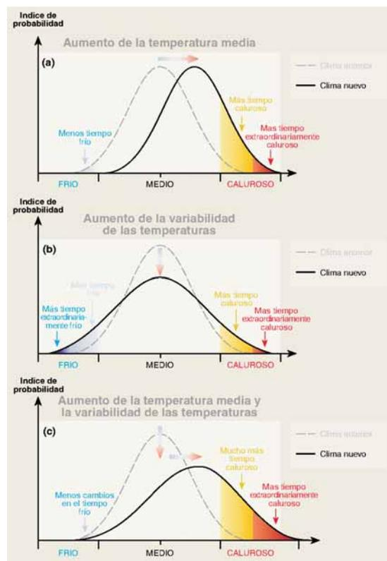
Gráfico 1. Diagramas esquemáticos que muestran los efectos sobre las temperaturas extremas cuando: a) Aumenta la temperatura media; b) Aumenta la varianza y se mantiene la temperatura media; c) Aumentan tanto la temperatura media como la varianza.
