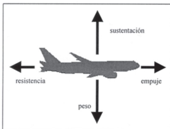
FIGURA 1. Fuerzas que actúan sobre el avión durante el vuelo.
