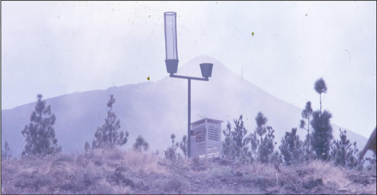
Captaniebla cilíndrico, pluviómetro y garita meteorológica (equipada de termo - higrógrafo). Los Realejos - Piedra de los Pastores (1600 m). Zona superior del pinar canario. La precipitación de niebla es relevante cuando la capa nubosa alcanza cotas elevadas sobre las laderas norte de Tenerife.
