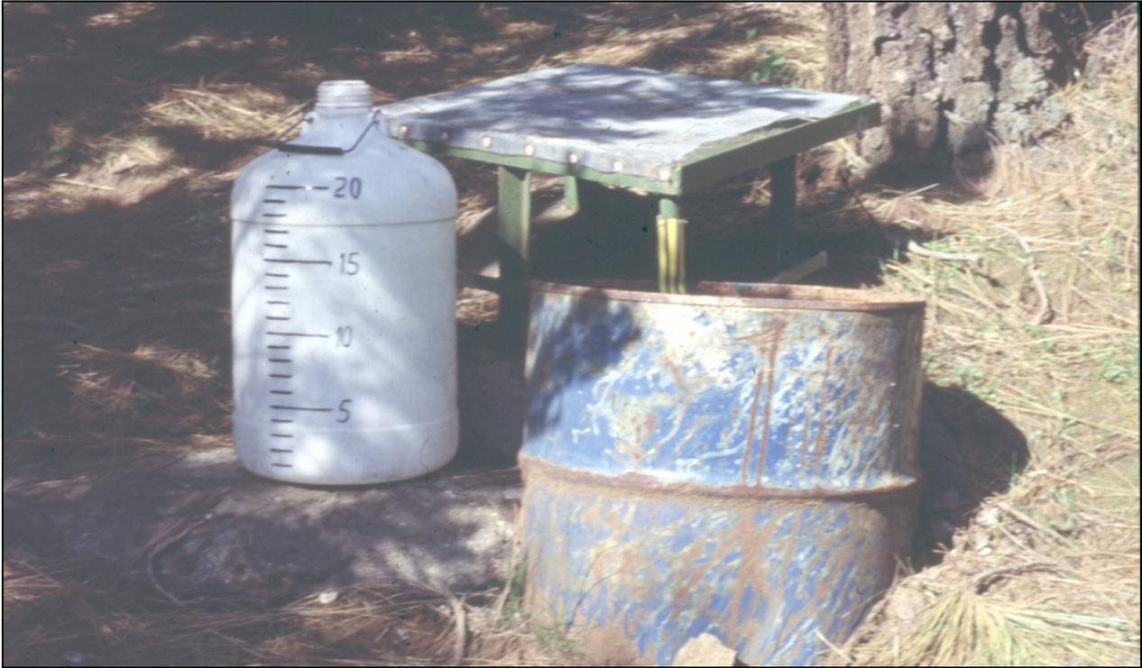
Mesa pluviométrica de 50\*50 cm<sup>2</sup> colocada debajo de un pino canario. El depósito recolector de la precipitación está soterrado. La **precipitación de niebla** es escasa en los pinares de Tenerife.
