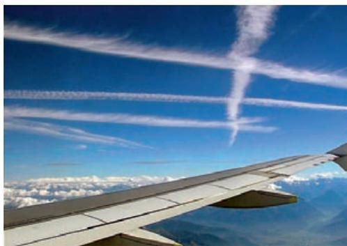
pies). El vapor de agua procedente de la combustión, al ponerse en contacto con la atmósfera, se sublima de forma casi instantánea, formándose pequeños cristales de hielo. Dicha sublimación no se produce hasta que los gases no se han alejado una centena de metros de la de tobera y se ha disipado el calor generado en la misma; por eso las estelas aparecen, vistas desde tierra, a cierta distancia de los motores.
