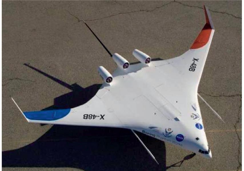
*El vehículo de pruebas de vuelo X-48B fue desarrollado por Boeing Phantom Works en cooperación con la NASA y el laboratorio de Investigación de la Fuerza Aérea de los Estados Unidos para recopilar información detallada sobre las características de estabilidad y control de vuelo, especialmente durante despegues y aterrizajes.*
