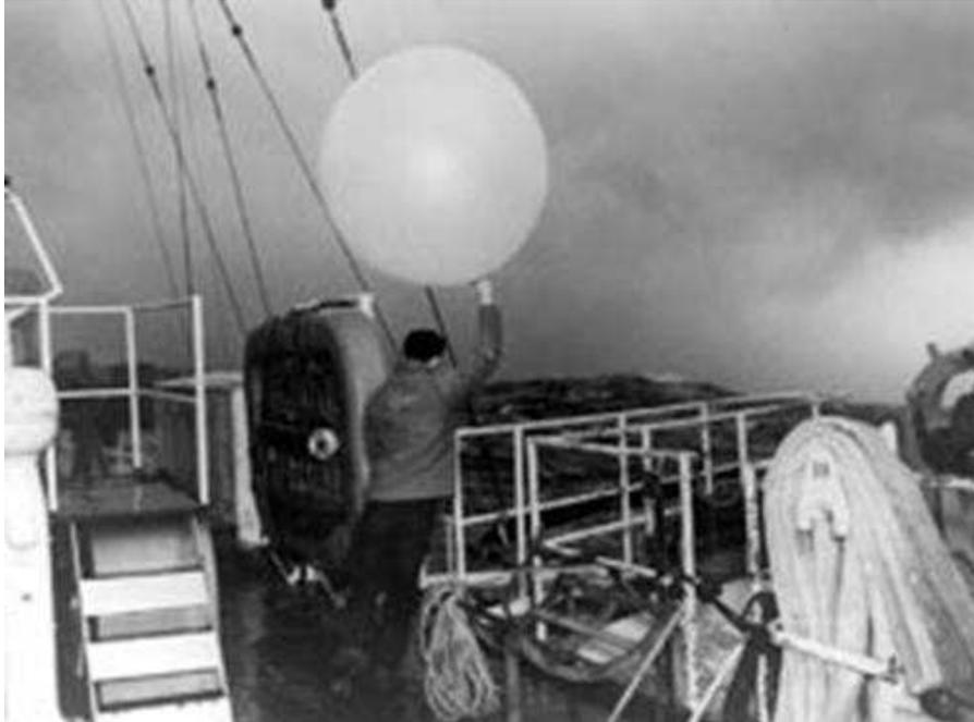
**Globos como el de la figura eran soltados cada seis horas desde la cubierta de los barcos para tomar datos meteorológicos en la vertical, llegando incluso hasta los 15.000 m de altura.**
