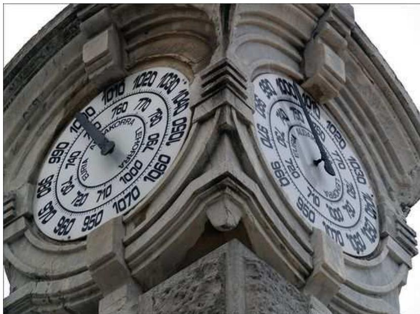
Figura 9.- Primer plano de 2 de las esferas del barómetro de La Concha. Las indicaciones de la presión atmosférica están graduadas tanto en milímetros de mercurio como en hectopascals.
