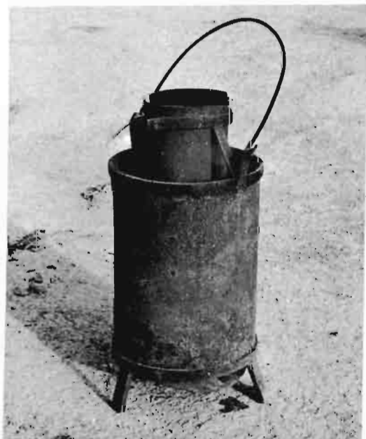
Fig. 3.—Quemador de carbón activado con yoduro de plata.
