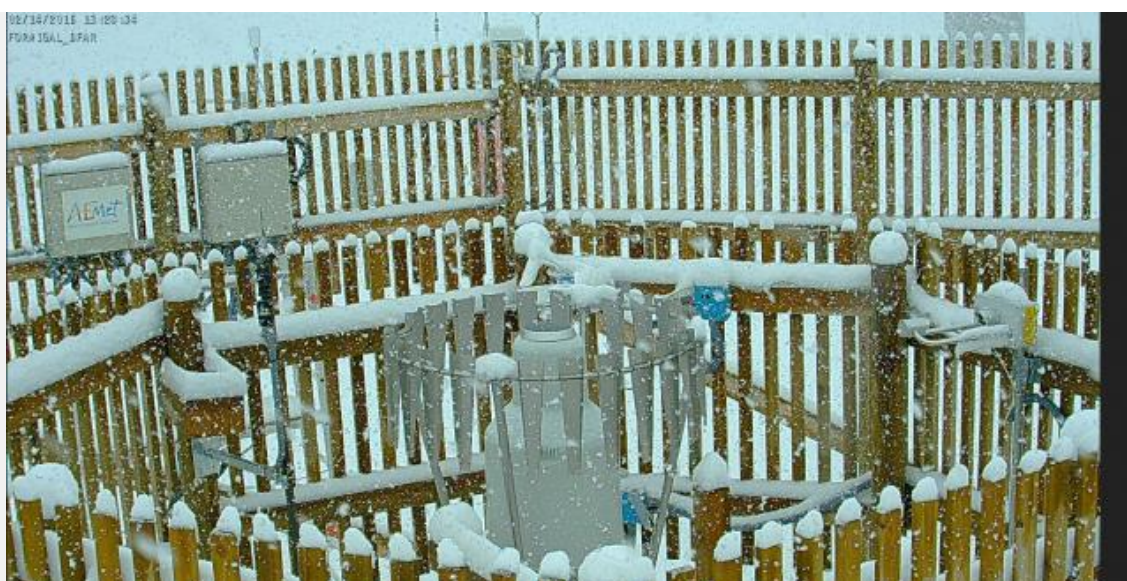
Figura 4. Vista del interior del DFAR de Formigal-Sarrius con el pluviómetro de pesada y el sensor de tiempo presente (Disdrómetro) en interior del anillo central.
